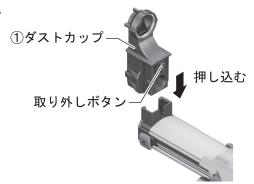
「ダストカップ①②と壁との接触面が摩耗し、吸じん中に粉じんが吹き出る原因になっているときは、新しいダストカップ①②と交換してください。
