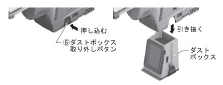
2. 取り外したダストボックスを、かたい表面の所に数回軽く当てます。 粉じんがダストボックスの底部に集まり、後処理がしやすくなります。 3. ダストボックスの底部にたまった粉じんを 捨てます。
