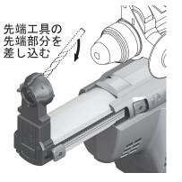
4. 電動工具本体の取扱説明書に記載され ている、先端工具の取り付け手順に従 って、先端工具を取り付けます。
