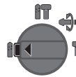
Posisi untuk membor tanpa getaran di kayu, logam, keramik dan bahan sintetik serta untuk menyekrup.
