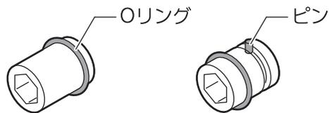
2. ソケットを先端工具差し込み部④に差し込みます。
