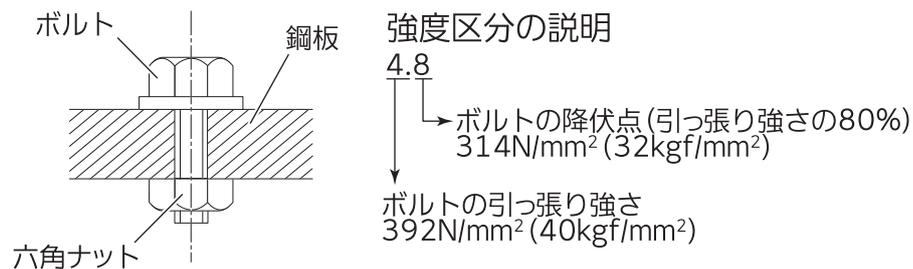
管理方法として、必ずトルクレンチで締め付けトルクを確認してください。
