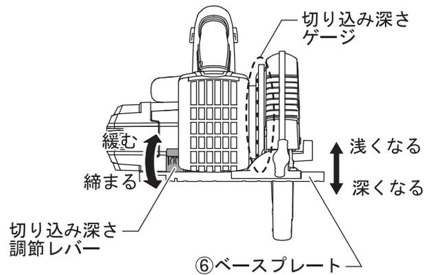
1. 切り込み深さ調節レバーを矢印の方向に上げて緩めます。
