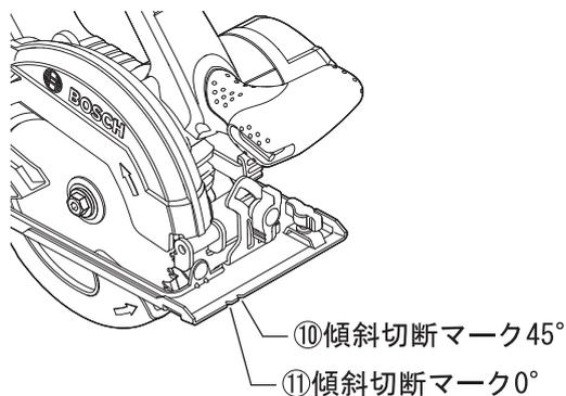
傾斜切断マークの切り欠き幅は、のこ刃の厚さを含んでいます。
