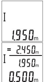
如要启动测量，短按测量按键 **2**。当前测量值 **c** 会显示在显示屏下面一行中。激光束关闭。
