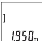
Pour déclencher la mesure, appuyez brièvement sur la touche de mesure **2**. La valeur de mesure actuelle **c** s'affiche sur la ligne inférieure de l'écran. Le faisceau laser s'éteint.
