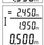
Para conectar el rayo láser, presione brevemente sobre la tecla de medición **2**. Para activar otra medición, presione de nuevo brevemente sobre la tecla de medición **2**. En la línea inferior se indica el valor de medición actual **c**. En la línea del medio se indica el valor de medición precedente **b**. En la línea superior se indica la auto-suma **a** (suma de valores de medición actuales y precedentes).
