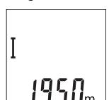
Para activar la medición, presione brevemente sobre la tecla de medición **2**. El valor de medición actual **c** se indica en la línea inferior del display. El rayo láser se desconecta.
