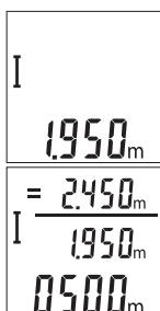
按一下測量按鈕 2 以開始進行測量。實際測量值 c 隨即顯示在螢幕的下方列中。雷射光束隨即結束。
