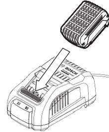
2. 充電するバッテリー⑦を充電器のバッテリー挿入口に差し込みます。
