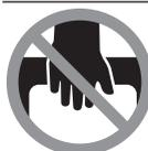
切勿從滑動臂的把手處提起電動工具。
